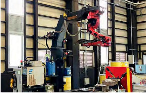
天吊マルチワーク溶接ロボットシステム※
