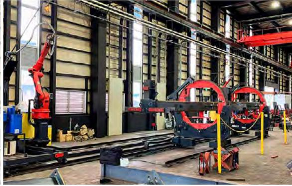
柱大組立溶接ロボットシステム※
