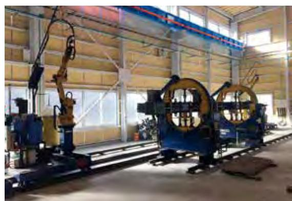
**REGARC™** 鉄骨柱大組立2アーク溶接システム
