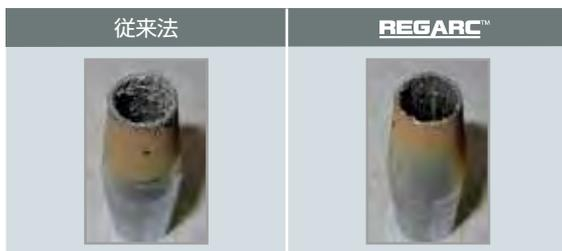
図7 ノズルの付着スパッタ状況(下向レ型開先)
