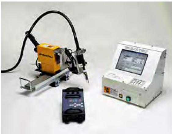
図4 小型可搬型溶接ロボット「石松」の構成
